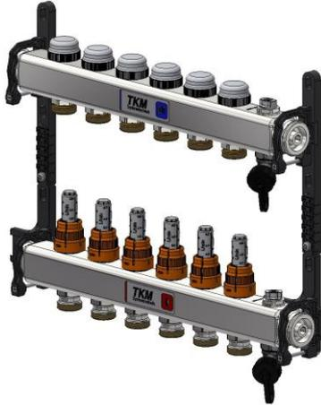
Die Verteiler aus Edelstahl AISI 304 eignen sich für die Verteilung und Regelung in Hoch- und Niedertemperatur-Heizungsanlagen. Die 1" IG-Gewinde der Anschlüsse am Kopf entsprechen der ISO 228. Die Abgänge für die Verteilungskreise sind als 3/4" EUROKONUS-Anschlüsse aus Messing CW617N, ausgeführt. Die Verteiler werden paarweise als Vor-/Rücklaufbalken geliefert und sind schallgedämmt auf Konsolen vormontiert.
